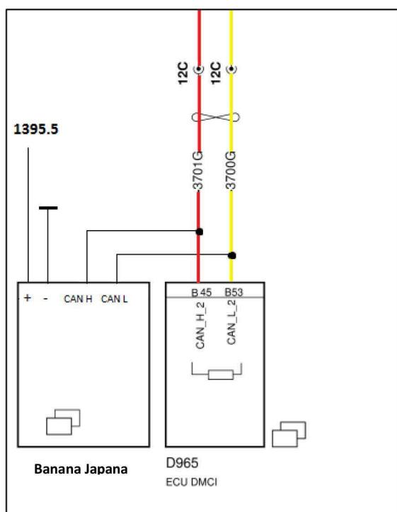
Красный/Желтый провода, согласно схеме. Питание эмулятора подключить к толстому красному проводу в разъёме 12C +15KL (+24В после замка зажигания.)
