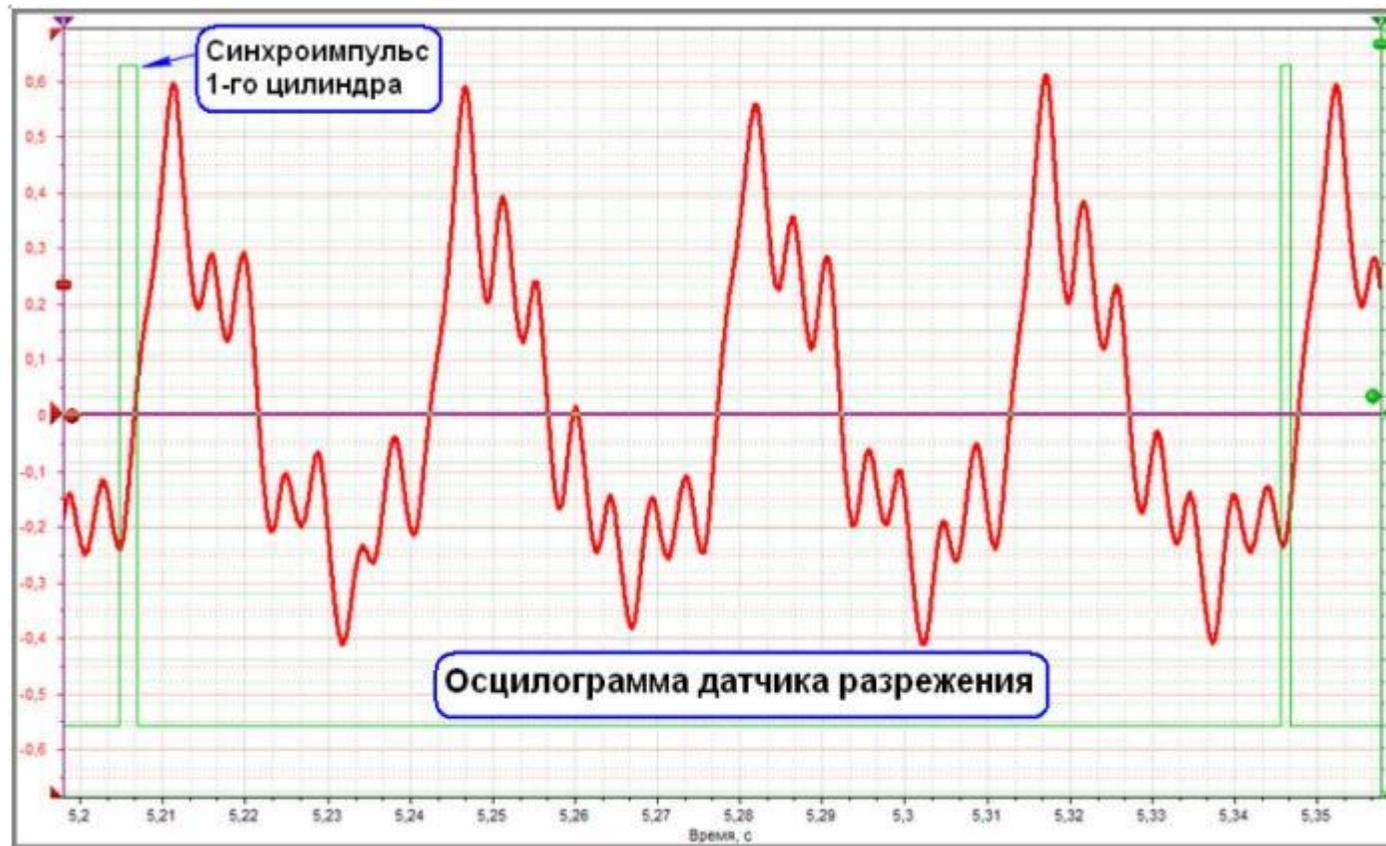
На нижней осциллограмме видно, что ВМТ, по данному датчику, практически не имеет расхождений с указанием ВМТ датчиком положения коленвала.
