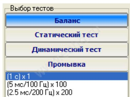
Баланс. Состоит из трёх тестов по проверке форсунок на баланс, без снятия их с двигателя. При выборе раздела, его кнопка подсвечивается голубым цветом. Параметры тестов показаны в выпадающем меню. Выбор производится наведением курсора мыши на необходимый тест и щелчком на нем левой кнопки мыши. Все движки ползунков настроек становятся в положение отображения параметров данного теста.
