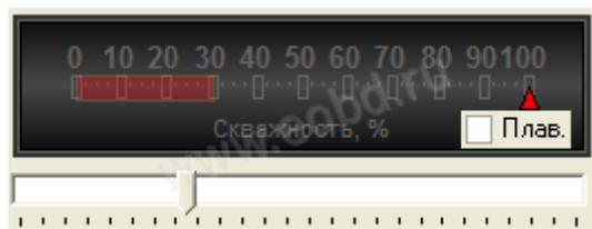
Скважность. Задается скважность удерживающих импульсов либо импульсов открытия форсунки.
