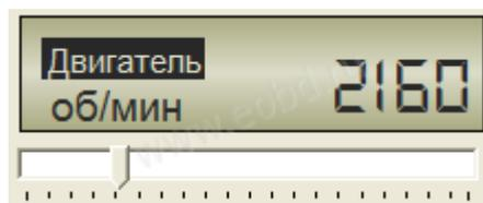
При проведении Динамических тестов и имитации фазированного впрыска этой настройкой задается частота следования импульсов открытия
