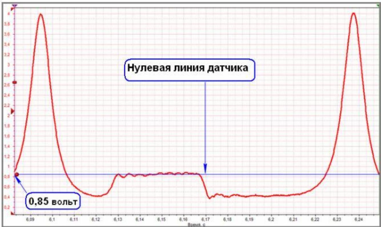
Каждый цифровой датчик имеет свой «ноль» это некоторое напряжение, имеющееся на выходе в состоянии покоя.
