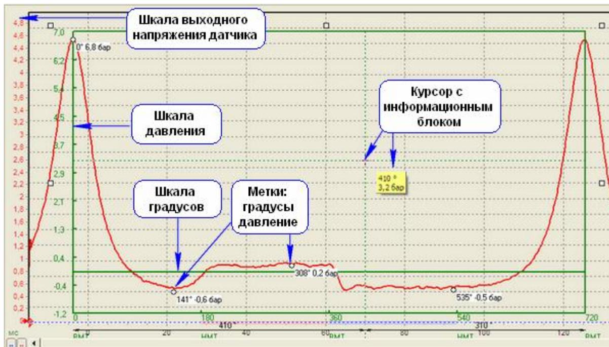
На акте выпуска топливовоздушной смеси, значение давления в цилиндре практически не превышает атмосферного. Повышение давления в цилиндре на такте выпуска может быть вызвано малым проходным сечением выпускных каналов отработавших газов, причиной чего может быть малый ход открытия выпускного клапана, "забит" катализатор, глушитель или выхлопная труба.
