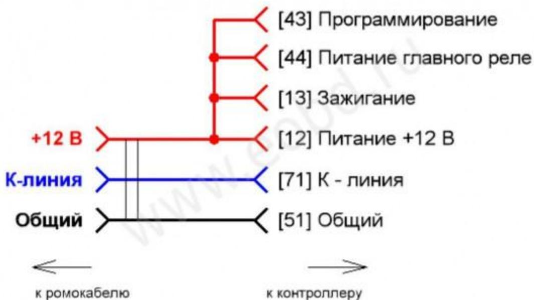
**Схема подключения Ромокабеля USB к ЭБУ "Bosch MP7.0"**
