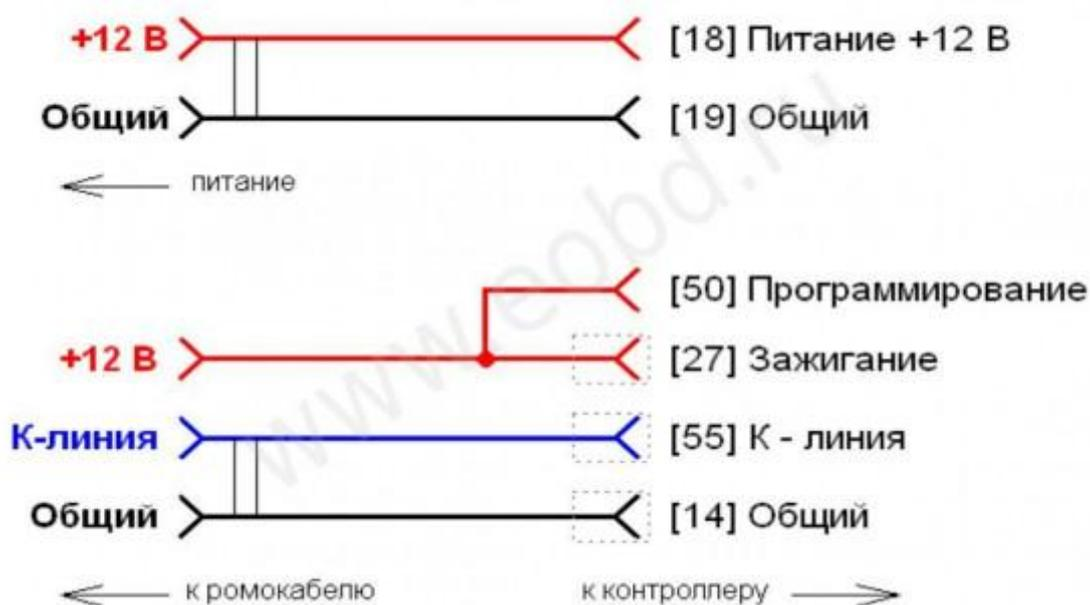
**Схема подключения Ромокабеля USB к ЭБУ "Bosch M7.9.7"**
