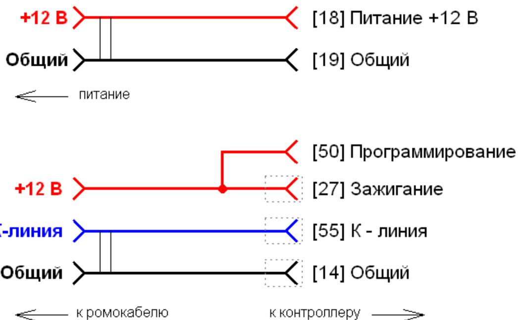
**Схема подключения Ромокабеля USB к ЭБУ "Январь 7.2"**
