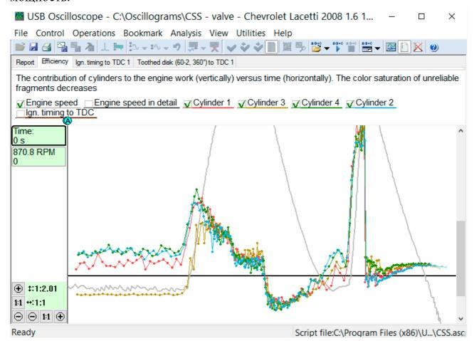
По графикам эффективности видно, что на начальном этапе проведения замеров цилиндр 3 (график эффективности жёлтого цвета) не работал совсем. Но во время первой перегазовки начал работать и далее работал нормально. Это измерение показало, что неисправен цилиндр 3, но не показало причину неисправности. Поэтому, был проведён повторный замер.
