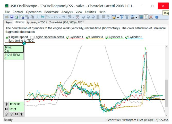
На этот раз в начале работали все цилиндры, но после первой перегазовки цилиндр 3 снова отказал. По последнему этапу измерений видно, что в этом цилиндре существенно ухудшилась компрессия. По результатам этих двух замеров был сделан вывод, что в цилиндре 3 периодически пропадала компрессия.
