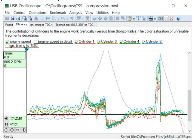
Здесь отчётливо видно, что график красного цвета, отображающий работу цилиндра 1, расположился ниже графиков остальных цилиндров при работе двигателя, практически, на всех режимах, а именно:
